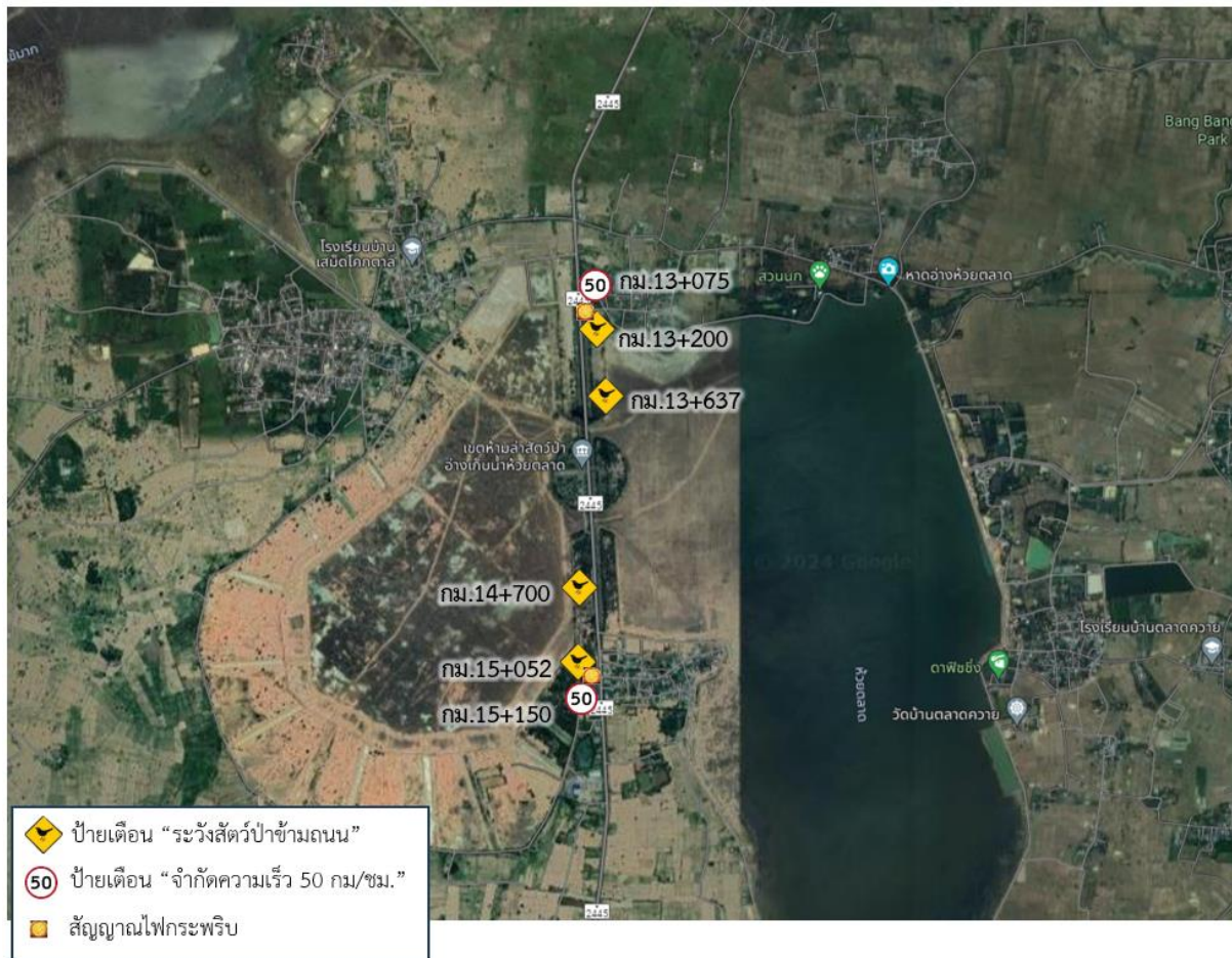
รูปที่ 4.4-6 ผังแสดงตำแหน่งการติดตั้งป้ายเตือน “ระวังสัตว์ป่าข้ามถนน” ป้ายเตือน “จำกัดความเร็ว 50 กม./ชม.” และสัญญาณไฟกระพริบ บริเวณก่อนผ่านเขตห้ามล่าสัตว์ป่าอ่างเก็บน้ำห้วยตลาด ในแนวเส้นทางโครงการ
