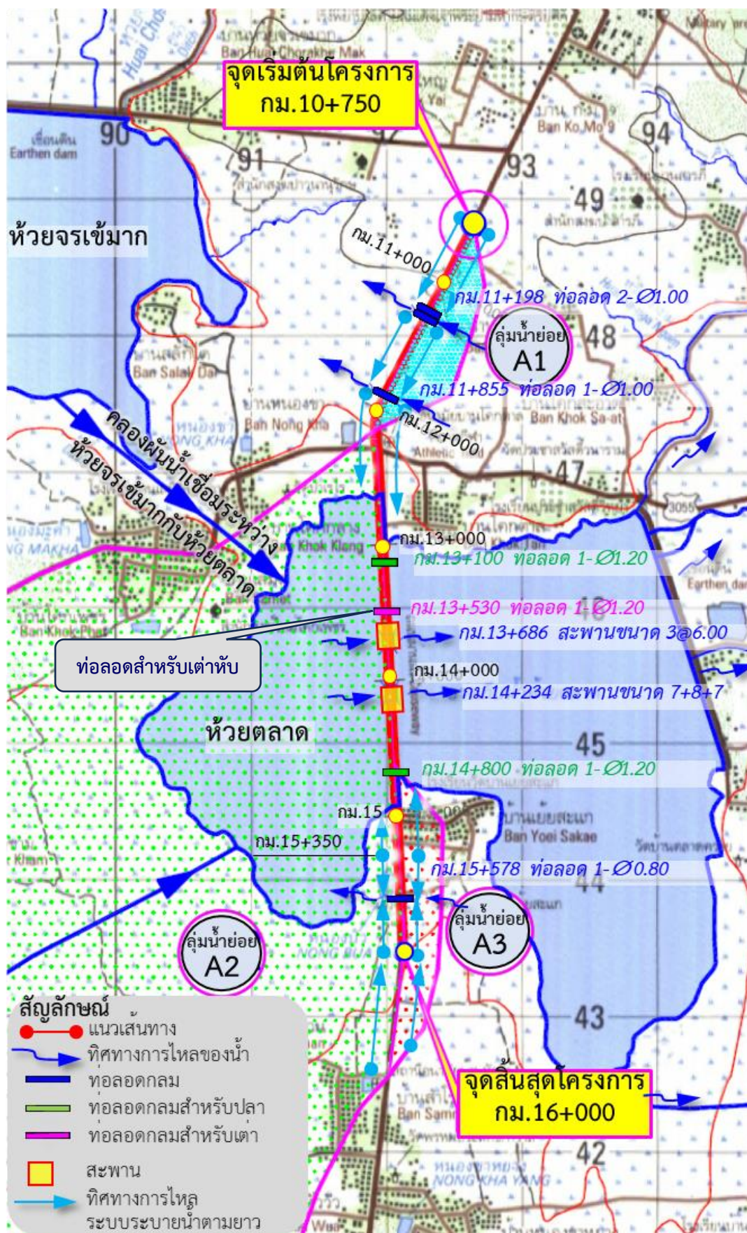
รูปที่ 4.4-11 แสดงตำแหน่งท่อลอดสำหรับสัตว์ป่าในอ่างเก็บน้ำห้วยตลาด (บริเวณที่พบเต่าทับ กม.13+530) <<กลับไปยังสารบัญ
